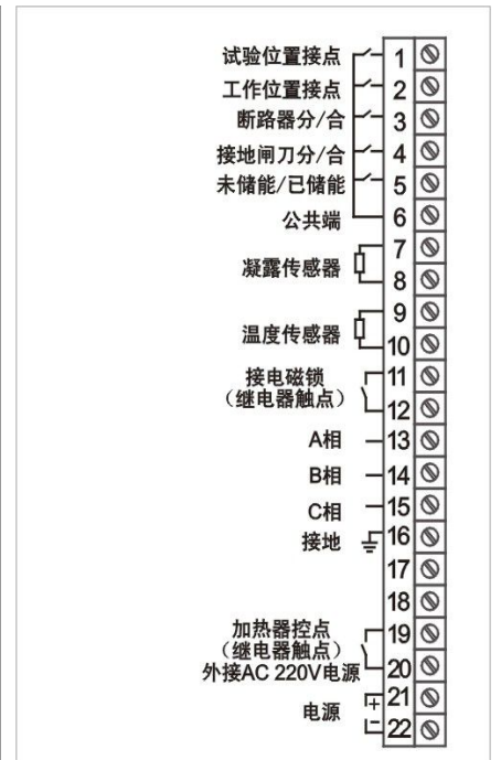
图 3: SH-K850B 系列产品接线图
