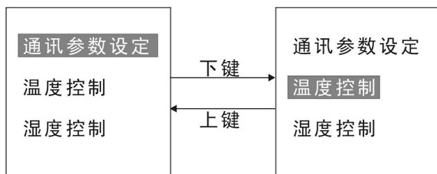
“通讯参数设定”有2项，分别是通讯地址和波特率，按“**下键**”或“**上键**”键可以在他们之间选择需要的项，按**确认**键，进入这个项，如需更改数值，按**确认**，输入正确密码“2000”，光标所指位置通过“**下键**”或“**上键**”使数值减少1或增加1，按“**确认**”一次，光标向右移一格；直到数值从左到右更改完毕，再按**确认**，保存当前输入的数据，输入正确的密码（如果没有输入正确的密码，系统提示“密码错误”，要求重新输入密码）；输完密码，光标所指数值左起第一位，具体更改方法同密码输入方法一致。
