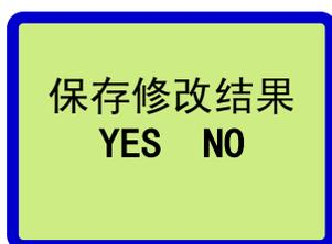
(10) 用户进入该项选择后, 按【↵】键进行保存修改结果复选, 同时装置设置了参数写入控制开关, 由硬件来控制参数的写入。如果用户想要保存修改结果, 请按【↵】键选中 YES 项, 同时把参数写入控制开关拨到 ON 位置。按【ESC】键返回装置正常工作状态, 同时参数被写入装置内存【EEPROM】中, 完成后, 把参数写入控制开关拨到 OFF 位置。
